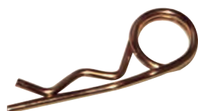
Goupille Béta, double spire L : 72 mm Ø = 3 mm Q06 FA 21 L : 90 mm Ø = 4 mm Q06 FA 22
