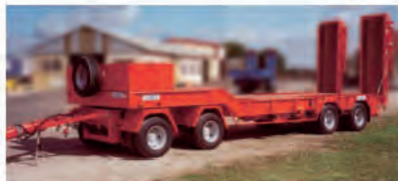
Remorque avec avant-train tournant 2 ou 3 essieux Porte-engin ou plateau droit
