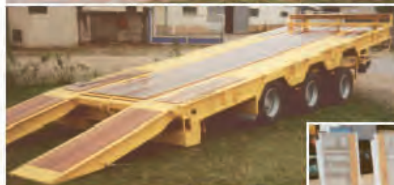
Remorque de 1 à 3 essieux centraux Plateau basculant ou plateau fixe
